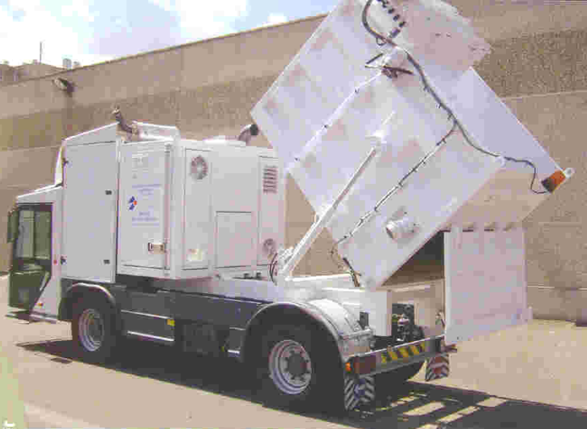
Standard Industrie International a conçu le Valnet comme un véhicule léger d'aspiration destiné au nettoyage et au pompage de produits secs et en vrac
